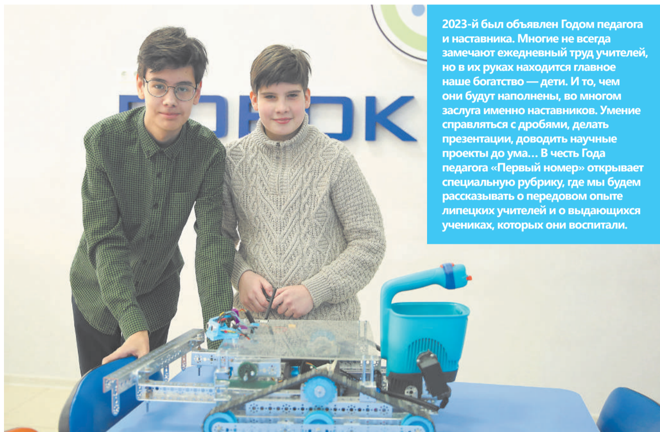
Компактный снегоуборщик работает на базе платформы Arduino
